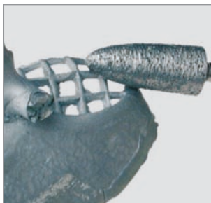
Rifinitura e sgrossatura Conformación y gran reducción de material Contorno e desgaste grosso de material
