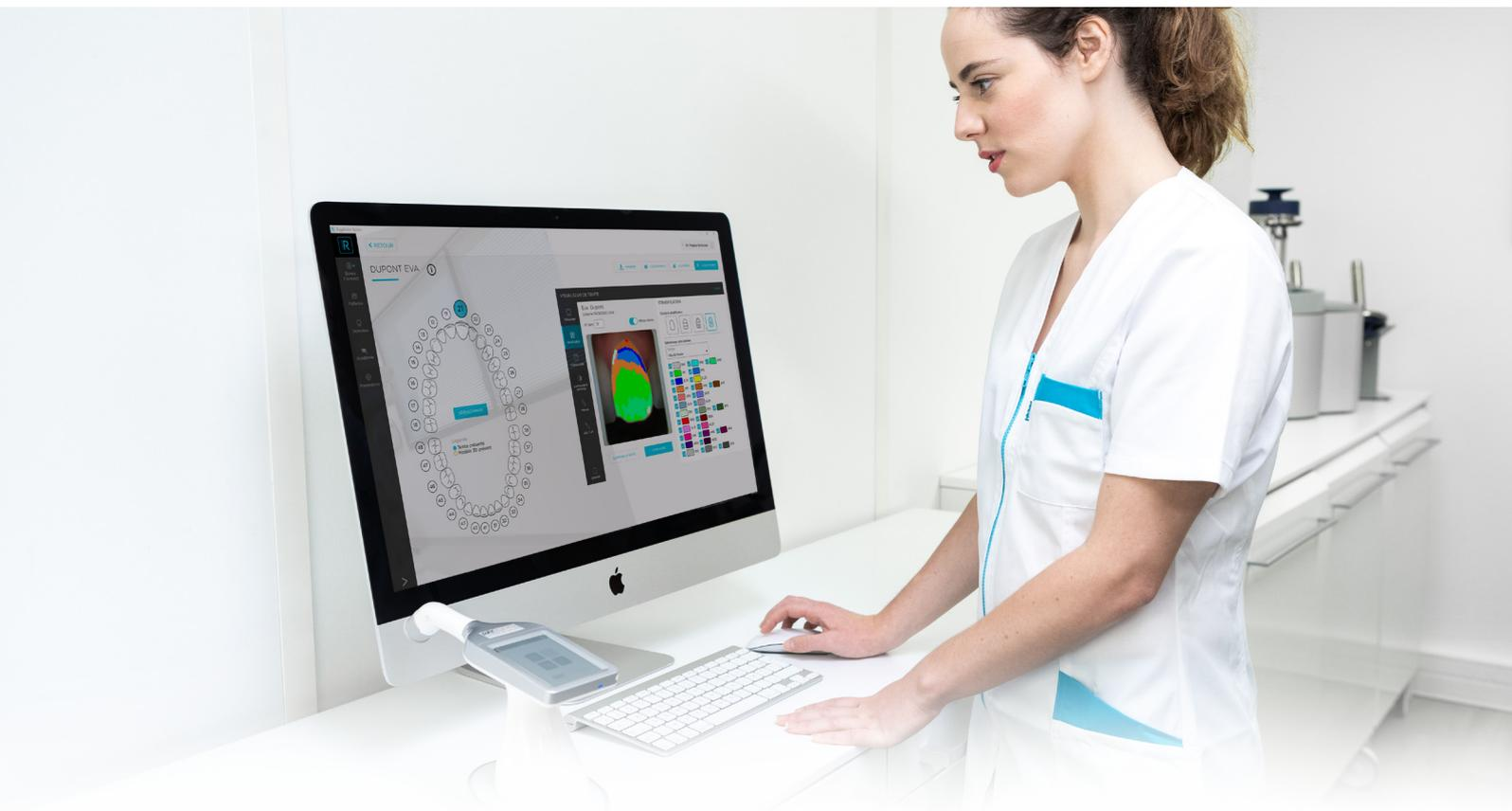
El software **Rayplicker Vision** permite recuperar, analizar y archivar las adquisiciones obtenidas con un dispositivo de toma de color Rayplicker Handy.
